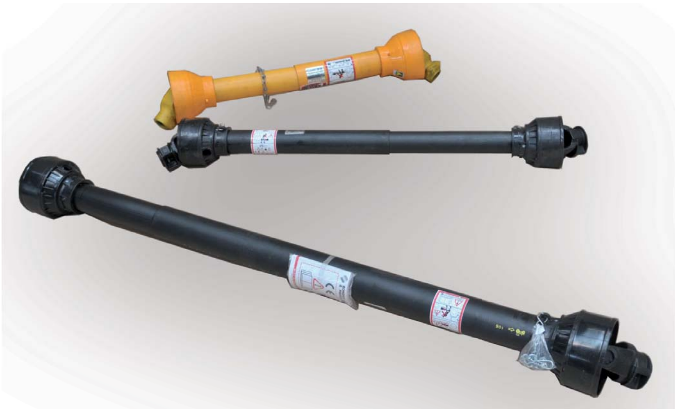
Każdy wał powinien być osłonięty na całej swej długości, posiadać nieuszkodzoną osłonę oraz łańcuszki zabezpieczające ją przed obracaniem się. Piktogramy umieszczone na wale ostrzegają przed potencjalnymi zagrożeniami
