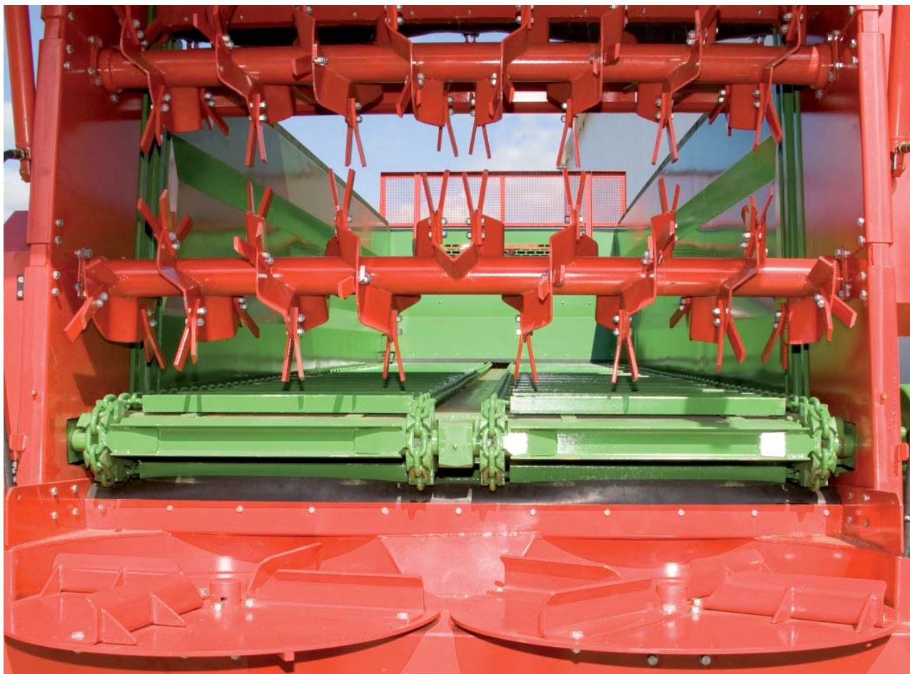
Adapter rozdrabniająco dwuwalcowy poziomy oraz dwa talerze mechanizmu szerokiego rozrzutu rozrzutnika N262
