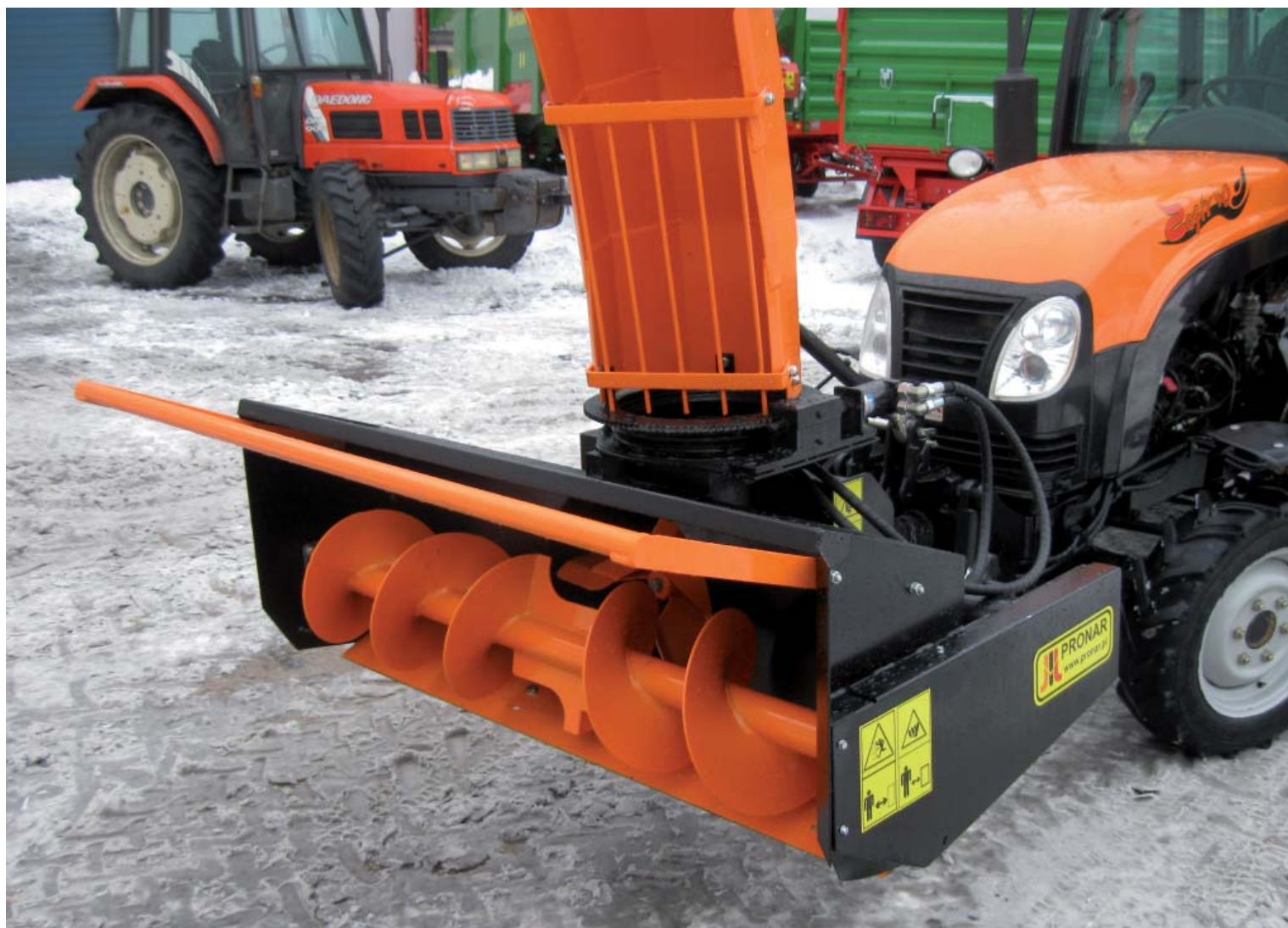
Zgarniacz odśnieżarki wirnikowej OW1.5 służy do kruszenia i transportowania śniegu do środka maszyny. Należy zadbać, aby był on oczyszczony z resztek materiału zawierającego sól, która powoduje szybszą korozję elementów metalowych
