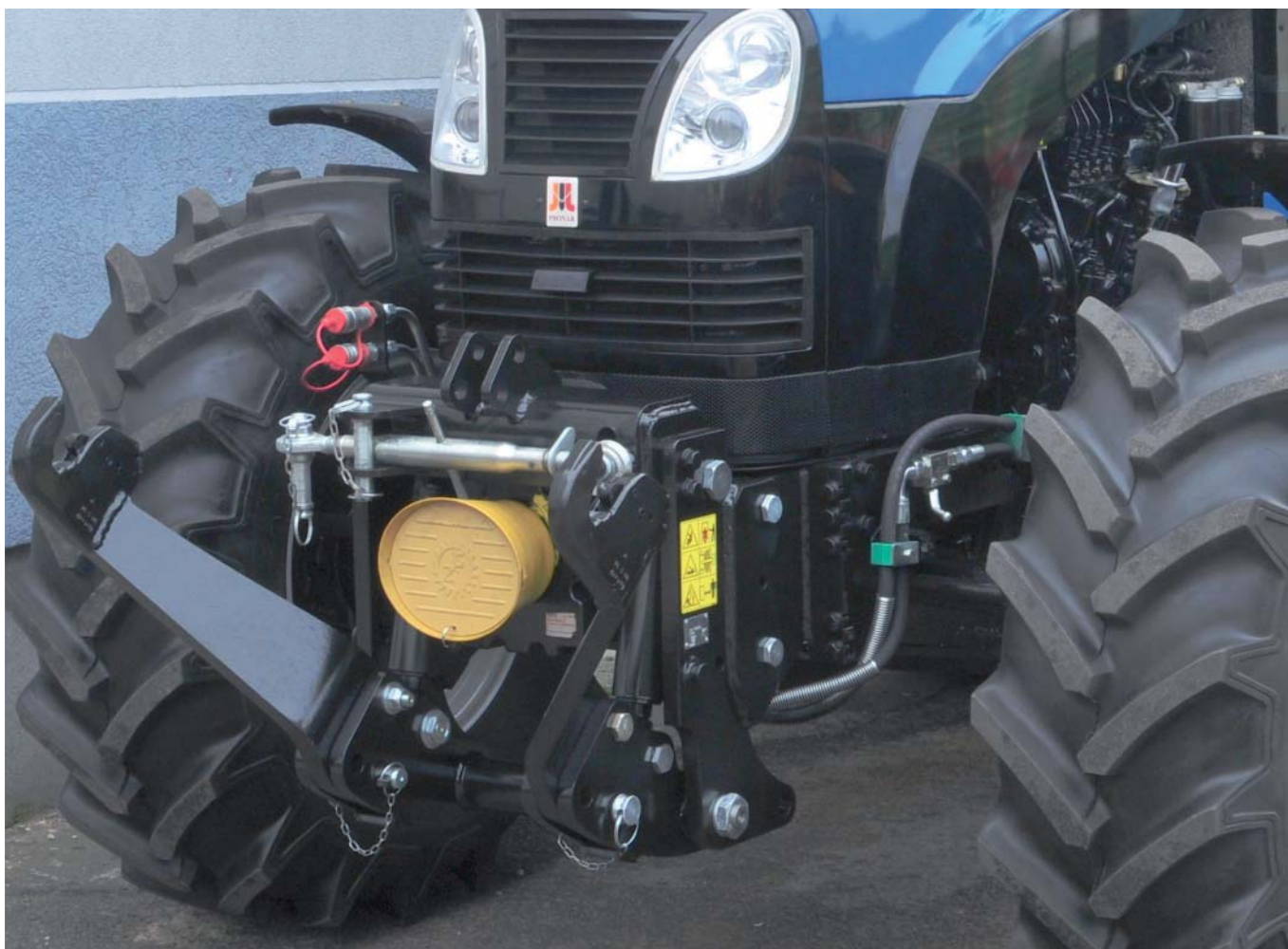
Ostłona elementu ruchomego eliminuje zagrożenie wynikające z obracających się podzespołów maszyny
