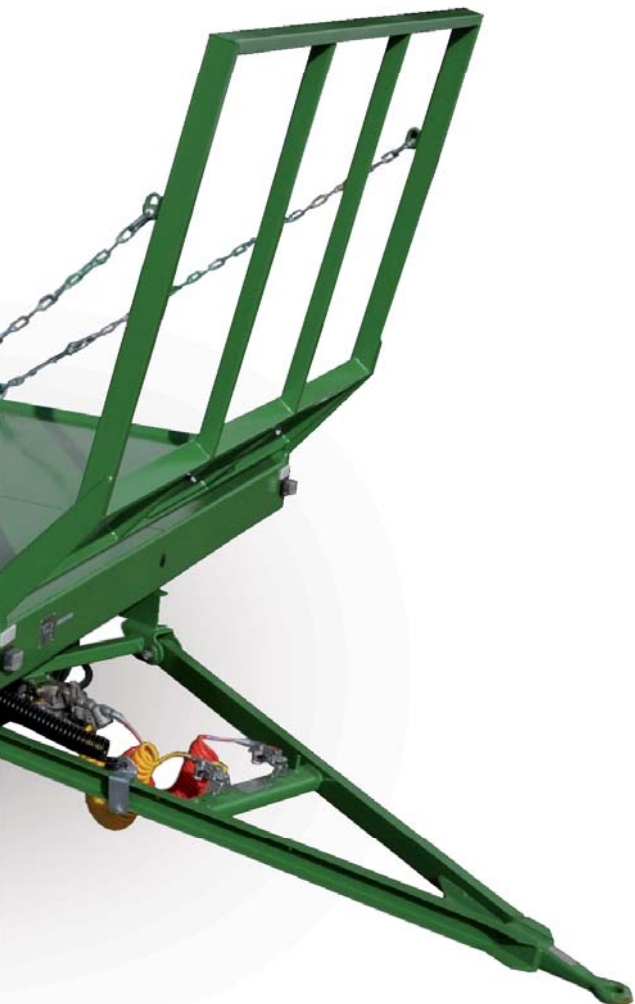
Dwupunktowy system mocowania drabinek, dający przy odpowiednim zamocowaniu ładunku możliwość rezygnacji z ciągłej podtrzymujących
