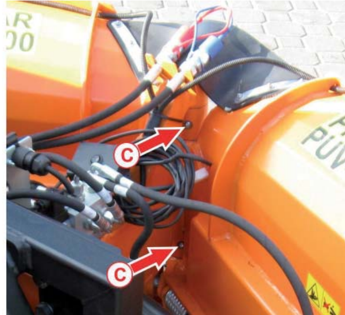
Punkty smarowania plugu PRONAR PUV-1600: A - tuleja obrotu kółka, B - ucho tłocznika siłownika hydraulicznego, C - czop obrotu odkładnic
