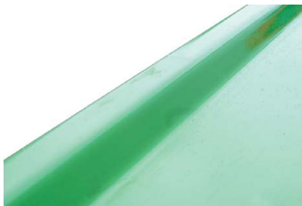
Wyprofilowane, zaokrąglone ranty boczne platformy zabezpieczają ładunek przed zsunięciem z przyczepy oraz eliminują ryzyko uszkodzenia folii bel podczas załadunku i transportu
